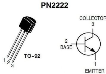
Il datasheet ci dice che il fattore beta ( $hFE$  o DC current Gain) va da un minimo di 35 con correnti di 1 mA fino ad un max di 300 con 150 mA e che si può usare fino a 30V e 600 mA, quindi più che adatto al nostro scopo.
