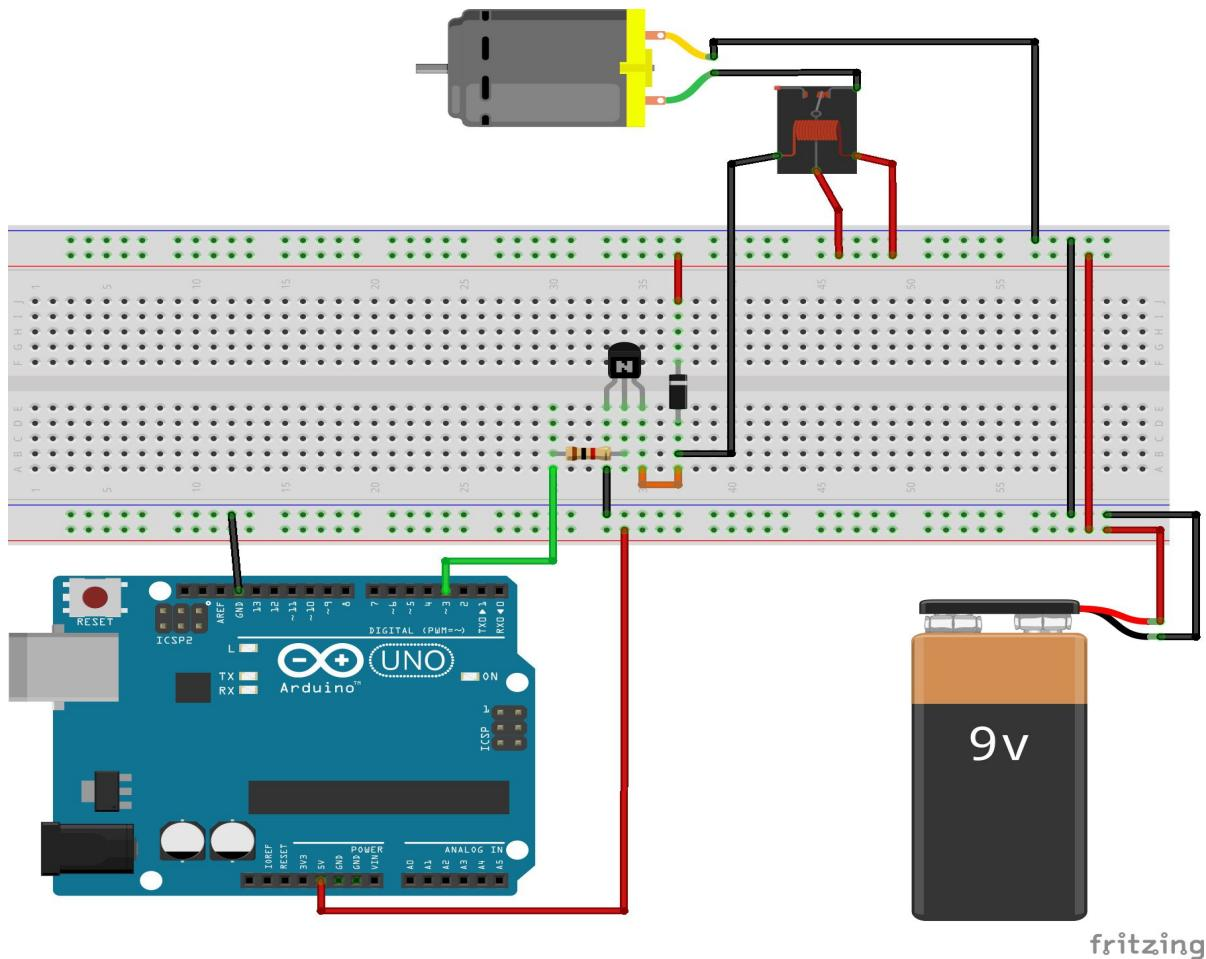
Il programma non presenta nulla di particolare in quanto si tratta solamente di impostare al valore alto l'uscita corrispondente al collegamento con la base del transistor, nel nostro caso il pin 3.
