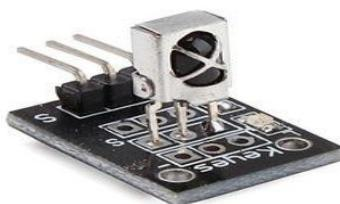
Si tratta di un sensore molto semplice da usare che possiede solo 3 contatti: positivo (R), negativo (G) e segnale (Y) e va collegato ai pin +5V, GND, e un pin digitale a nostra scelta. In questo modo il circuito diventa:
