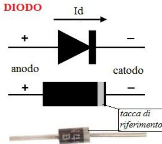
Come si vede il simbolo del diodo è simile a quello dei led, anch'esso ha una polarità da rispettare, in funzione del suo utilizzo, nel kit c'è un diodo con sigla 1N4007 come quello nella figura e la banda argento ci dice da che parte è il terminale negativo. Se viene inserito in un circuito al rovescio, impedirà il passaggio di corrente come un interruttore aperto.
