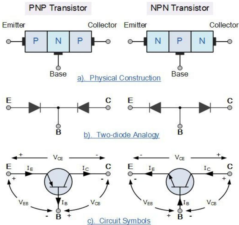
I transistors hanno diverse e più specifiche funzioni, per i nostri scopi il più semplice da usare è il tipo NPN e noi lo utilizzeremo come se fosse un interruttore elettronico, approfittando della sua caratteristica di amplificatore di corrente, infatti applicando una piccola corrente alla base avremo un flusso di corrente tra collettore ed emettitore pari al prodotto della corrente fornita e del fattore di amplificazione (beta)
