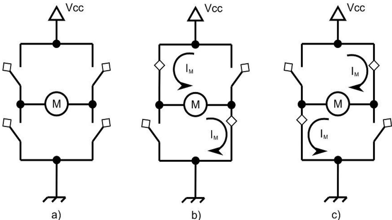
come si vede, dalla figura a) dove non circola corrente si può connettere il motore secondo b) oppure c) ottenendo i due sensi di circolazione, è importante NON connettere mai i due interruttori a destra o i due a sinistra contemporaneamente pena causare un cortocircuito. Il nostro integrato esegue queste connessioni in modo trasparente. Vediamo lo schema interno e come viene connesso ad un motore:
