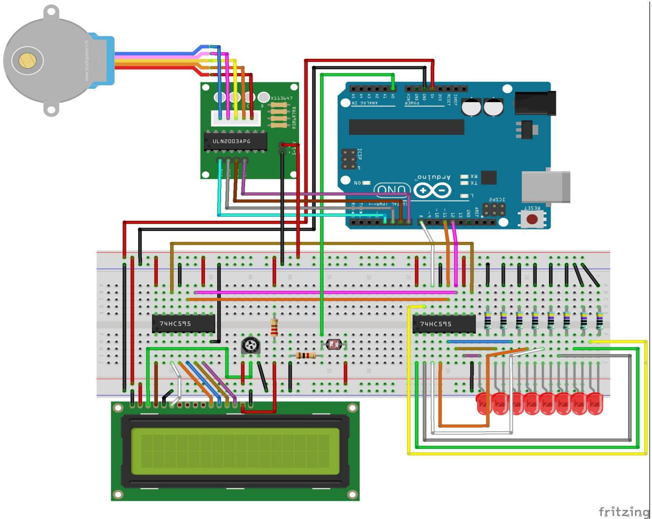
Lo spinotto del motore ha un verso solo per l'inserimento nel modulo di controllo, e i 4 ingressi (IN1...IN4) li collegiamo ai pin digitali da 4 a 7 di Arduino e questo è lo sketch:
