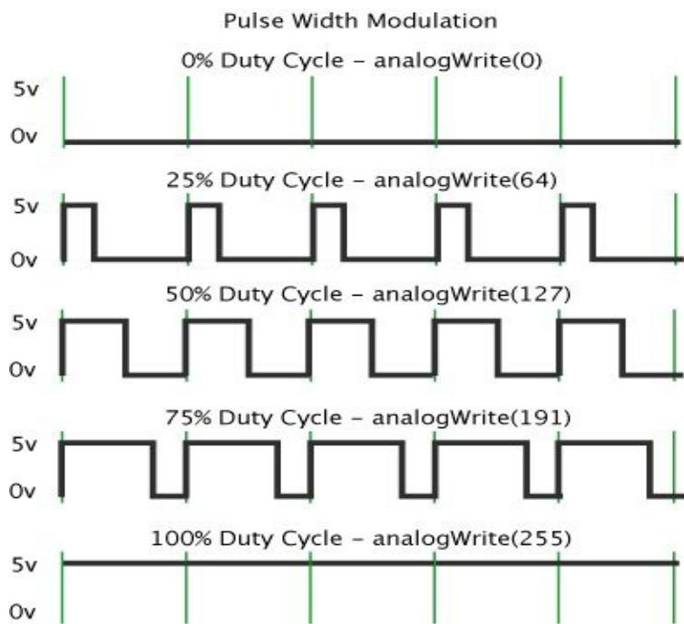
Vediamo qui 5 esempi di modulazione PWM con il valore corrispondente da assegnare all'istruzione **analogWrite()**. Nello sketch converto i valori del telecomando da 0 a 9 in un numero che va da 120 a 255 con l'istruzione **map()** che abbiamo già visto in passato, parto dal valore 120 in quanto ho verifivato che a valori inferiori il motore non riesce a ruotare, cambiando tipo/qualità di motore il valore può essere sicuramente inferiore.
